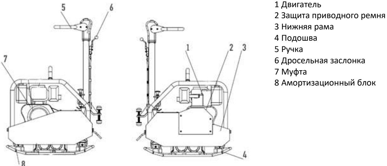
Фазовый угол, при котором эксцентриковый блок на эксцентриковом валу (15) и относительное положение зубчатого колеса фиксируются, другая группа эксцентрических блоков может быть изменена на фазу эксцентрического блока с помощью гидравлической системы управления ручкой (6). Путем изменения разности фаз между 2 группами эксцентриковых блоков меняется направление силы произведенной эксцентрическим блоком, чтобы трамбовка двигалась вперед и назад.
